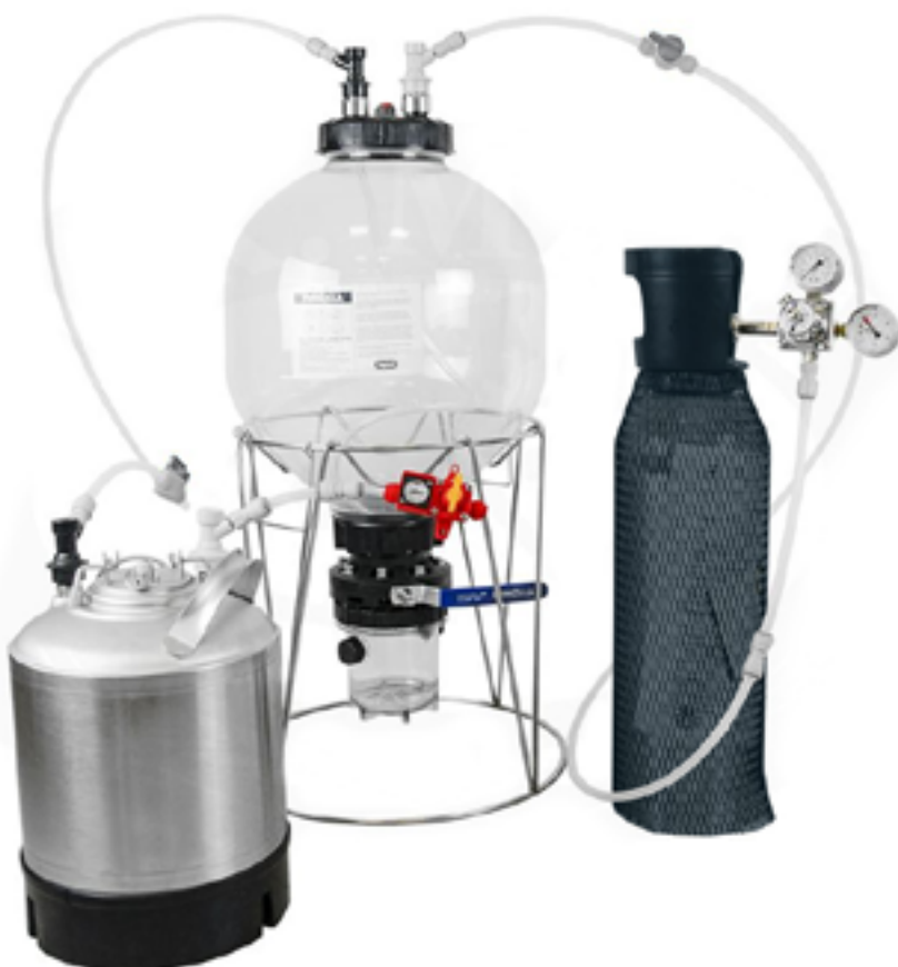
Abbildung 5 – Konfiguration des Kits für die isobare Fassabfüllung
